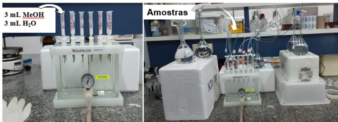
Figura 18- Esquema da realização do procedimento de extração (SPE) da água, preparatório para as análises cromatográficas de bisfenol A, dietilftalato e dibutilftalato.
