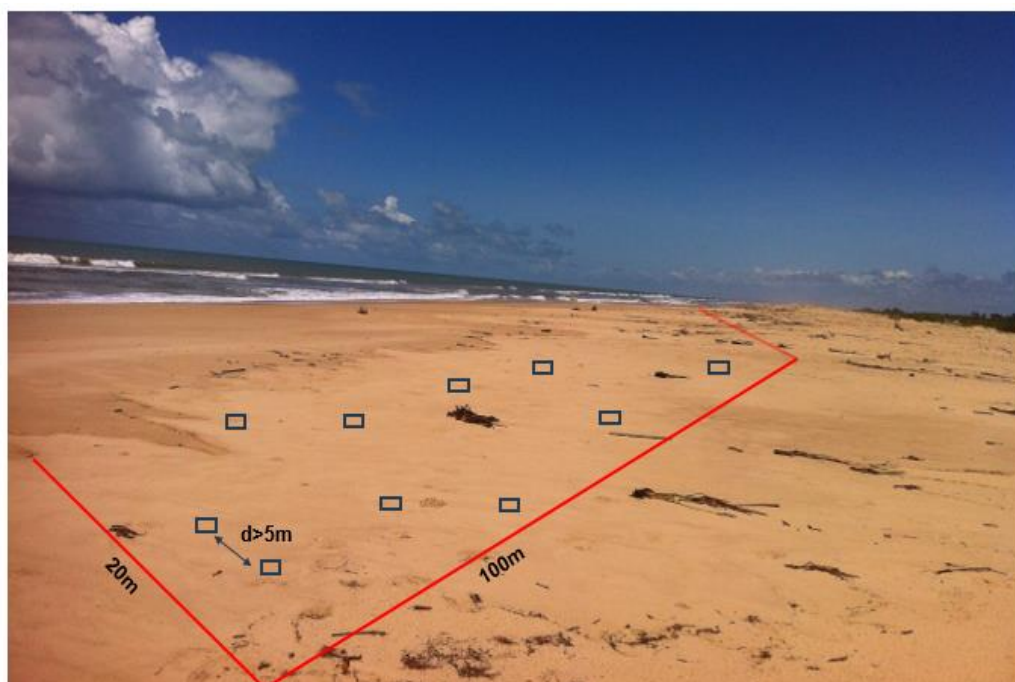
Figura 16- Imagem ilustrativa da metodologia de coleta de sedimentos em área de praia abarcando uma superfície de 2.000 m 2 (100 m x 20 m). Onde d é a distância mínima entre os quadrantes de coleta (50 cm x 50 cm).
