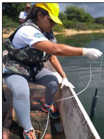
Figura 12 - Análise de água no Ponto 3 com a sonda Multiparâmetro, Porto da Folha/SE. Fonte: Acervo pessoal.
