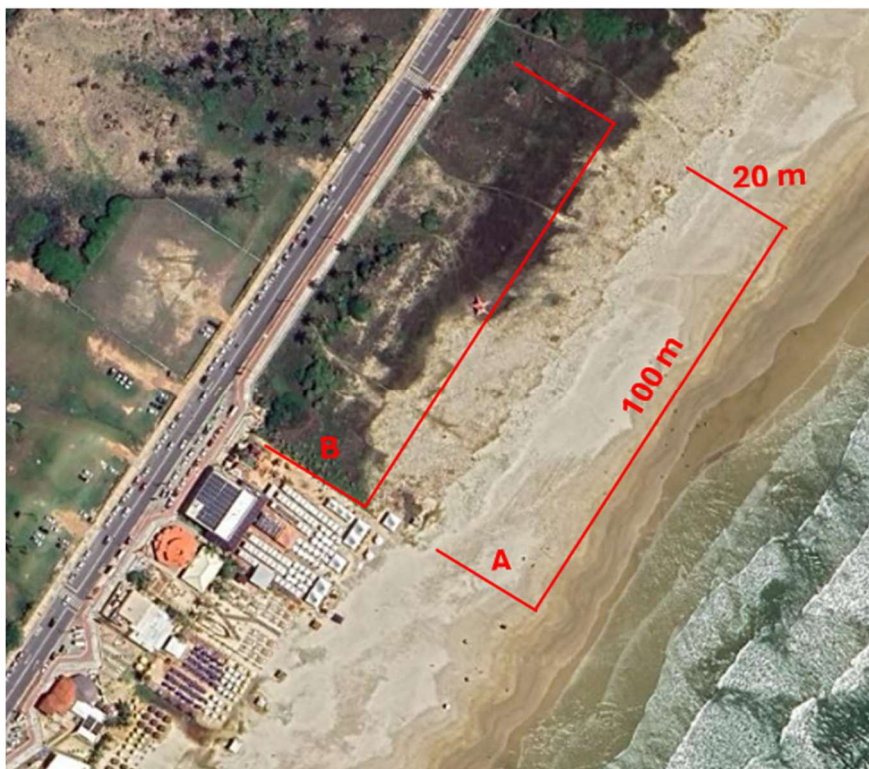
Figura 4 – Exemplo de delimitação das áreas de 2.000 m 2 (100m x 20m) para coleta dos macroplásticos, praia do Refúgio, Aracaju (SE). Legenda: A - Faixa de areia / B - Faixa de vegetação. Fonte: Autoria própria (2024).
