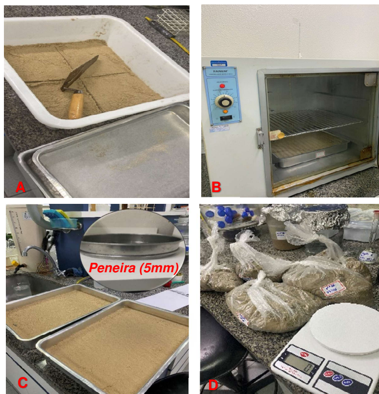
Figura 7 – Preparação das amostras de areia coletadas nas praias do: Artistas, Atalaia, Cinelândia, Refúgio, Robalo e Viral, no período de out/23 a abr/24 para processo de extração de Microplásticos. Quarteamento (A); Secagem (estufa a 60º) (B); Peneiramento(C); Pesagem (500g) (D). Fonte: Autoria própria.
