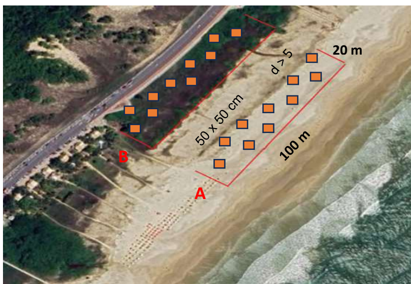
Figura 6 – Exemplo da delimitação das áreas de coleta de areia em 10 quadrantes (50 cm x 50 cm) contidos numa sessão de 100m x 20m (mesma área dos macroplásticos), para identificação de possíveis microplásticos, onde d é a distância mínima entre os quadrantes. A - Faixa da areia / B - Faixa da vegetação. Fonte: Autoria própria (2024).
