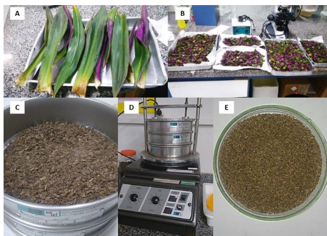
Figura 9: Fotografias do processo de preparo da amostra: (A) folhas de Tradescantia spathacea após lavagem e secagem; (B) folhas frescas cortadas e acomodadas em recipientes para secagem; (C) folhas secas preparadas para granulometria; (D) peneirador mecânico com peneiras da série Tyler 18-32 mesh ; (E) amostra com 18-32 mesh . Fonte: Arquivo próprio, 2018.
