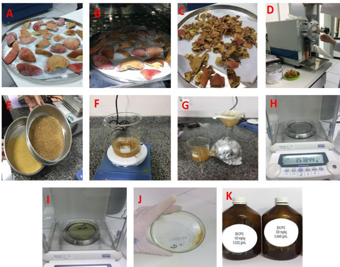
Figura 4. (A) Cascas congeladas; (B) cascas em estufa de circulação de ar à 50 \pm 5^\circ\text{C} ; (C) cascas desidratadas; (D) Cascas em moinho de facas; (E) Pó da casca em peneiras de granulometria; (F) Pó da casca suspenso em água destilada; (G) Suspensão filtrada em papel filtro; (H) peso da placa vazia; (I) peso da placa com o extrato seco; (J) Extrato sólido; (K) Extrato líquido.
