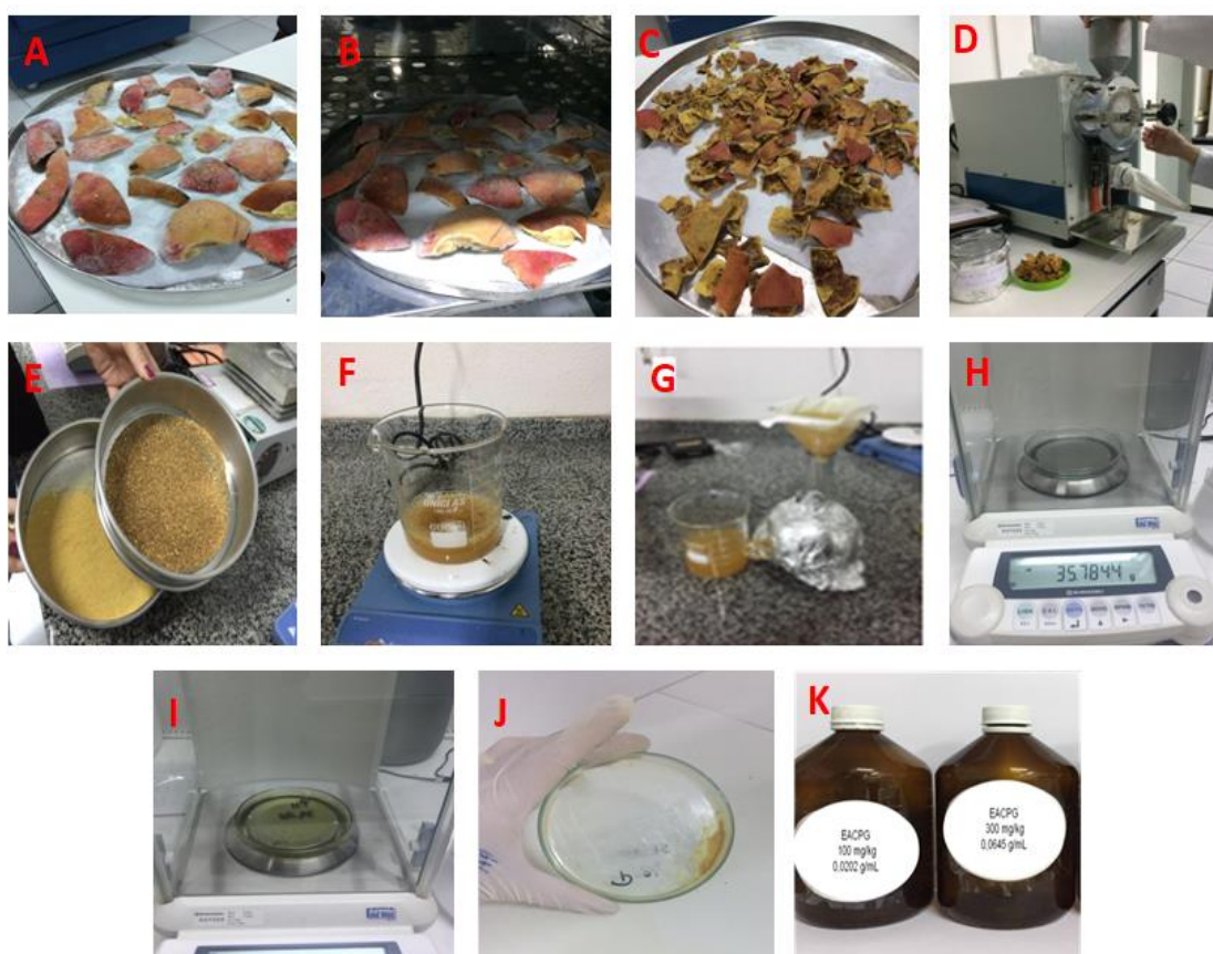
Figura 5: (A) Cascas congeladas; (B) cascas em estufa de circulação de ar à 50 \pm 5^\circ\text{C} ; (C) cascas desidratadas; (D) Cascas em moinho de facas; (E) Pó da casca em peneiras de granulometria; (F) Pó da casca suspenso em água destilada; (G) Suspensão coada em papel filtro; (H) peso da placa vazia; (I) peso da placa com o extrato seco; (J) Extrato sólido; (K) Extrato líquido.
