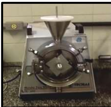
FIGURA 16: Moinho de facas utilizado para obtenção do granulado da casca de Punica Granatum Linn FONTE: Talita Santos Bastos, 2013 (imagem própria)
