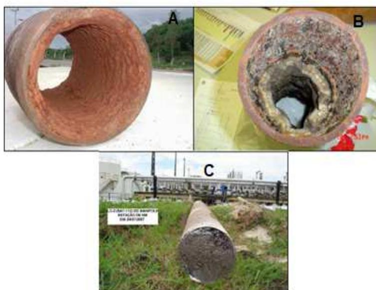
**Figura 2:** Incrustação de  $BaSO_4$  parcial (A), média (B) e total (C) de uma linha de 6 polegadas (GOMES et al., 2011).
