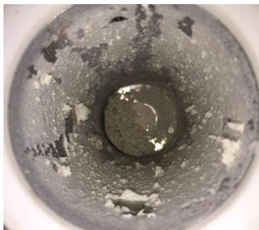
**Figura 9** – Sílica obtida no interior da câmara alta pressão. Condição: 150 bar; 40 °C; fluxo de solução 5 mL.min<sup>-1</sup>; vazão de CO<sub>2</sub> 15 mL.min<sup>-1</sup>; líquido iônico 0,5% BUT-DOA, razão molar 1:3 TEOS:H<sub>2</sub>O;
