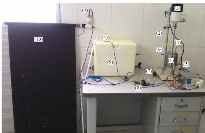
**Figura 11:** 1 – reator, 2 – condensador, 3 – agitador mecânico, 4 – sensores de temperatura, 5 – agitador mecânico, 5 – entrada de água quente no reator, 6 – saída de água fria no reator, 7 – Arduino, 8 – bomba volumétrica, 9 – reservatório de água, 10 – termossifão.
