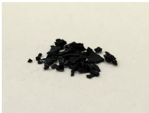
Figura 13: Frações asfálticas insolúveis em heptano após os processos de extração.
