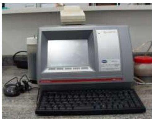
**Figura 20:** Densímetro digital DMA-4500 (Anton Paar).
