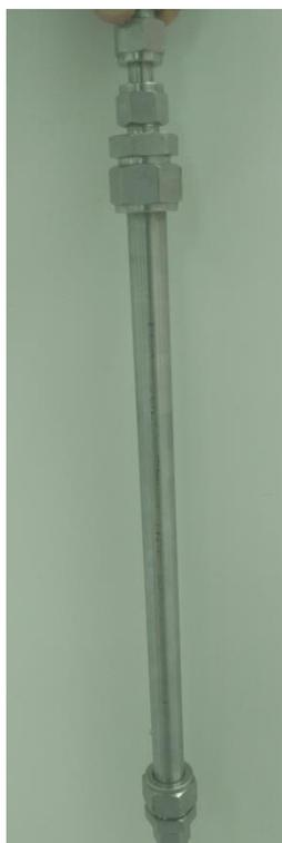
**Figura 7:** Câmara de secagem (de aço inox com volume útil de 30 mL) utilizada na secagem com CO<sub>2</sub> supercrítico.
