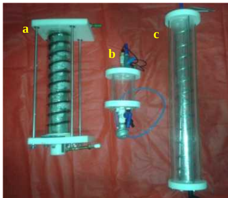
Figura 3.8 – Componentes do sistema sem as interligações hidráulicas: (a) – reator, (b) – cilindro para difusão de ar comprimido e (c) – caixa de mistura perfeita.
