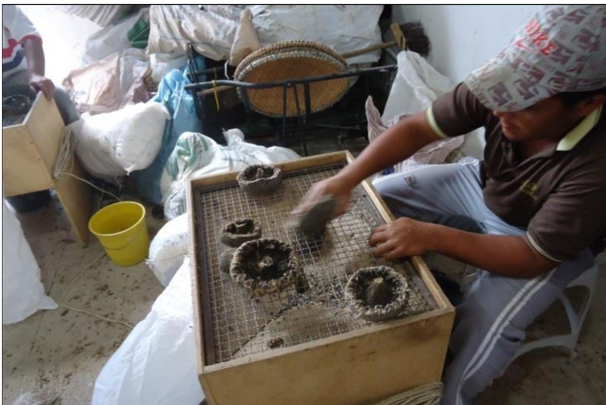
Figura 33. Separação dos aquênios do capítulo com separador aquênios de girassol desenvolvido durante a realização dos experimentos e posteriormente depositado patente: BR 20 2015 005197 8.
