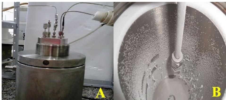
Figura 20: Fotografia mostrando a câmara de precipitação com volume de aproximadamente de 635 cm<sup>3</sup> conectada as linhas da unidade experimental (A) e a SiO<sub>2</sub> na parte interna da câmara de precipitação (B).
