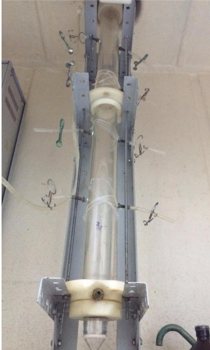
**Figura 22:** Reator semi-batelada tubular de ozonização
