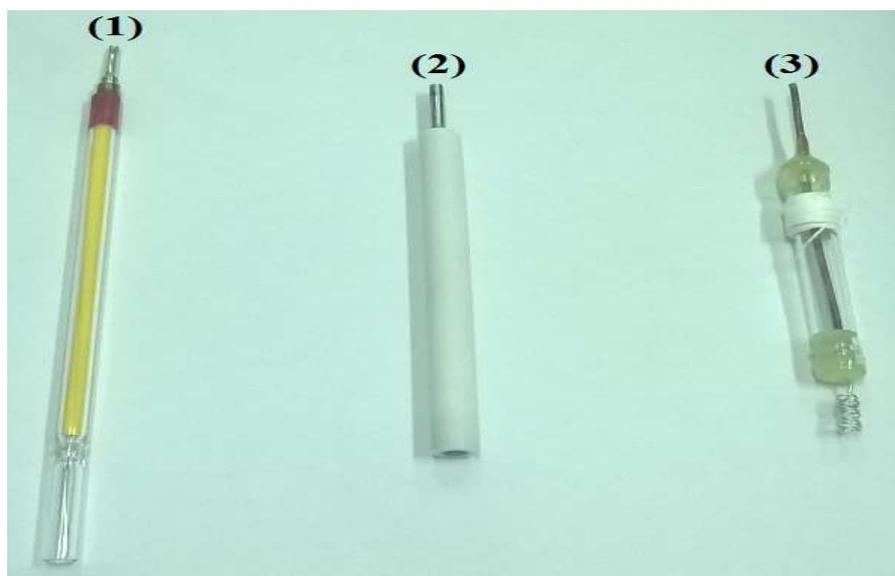
**Figura 10** - Eletrodos utilizados: (1) Eletrodo de referência (H<sub>2</sub>), (2) Eletrodo de trabalho (carbono vítreo) e (3) Contra eletrodo (fio de Pt).
