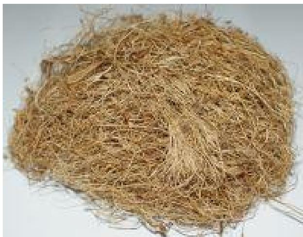
**Figura 3.** Fibra do dendê. Mesocarpo após a prensagem para extração do óleo.
