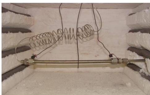
**Figura 17.** Vista do interior do forno tipo mufla, com o reator conectado e zona de pré-aquecimento de solvente da unidade de fragmentação de biomassa.
