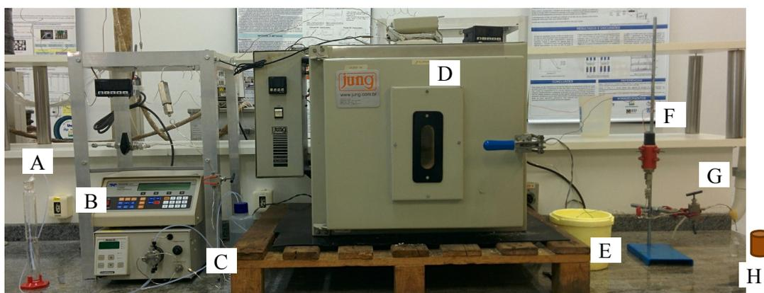
**Figura 16.** Unidade Experimental de fragmentação de biomassa em sistema líquido/gás pressurizados.
