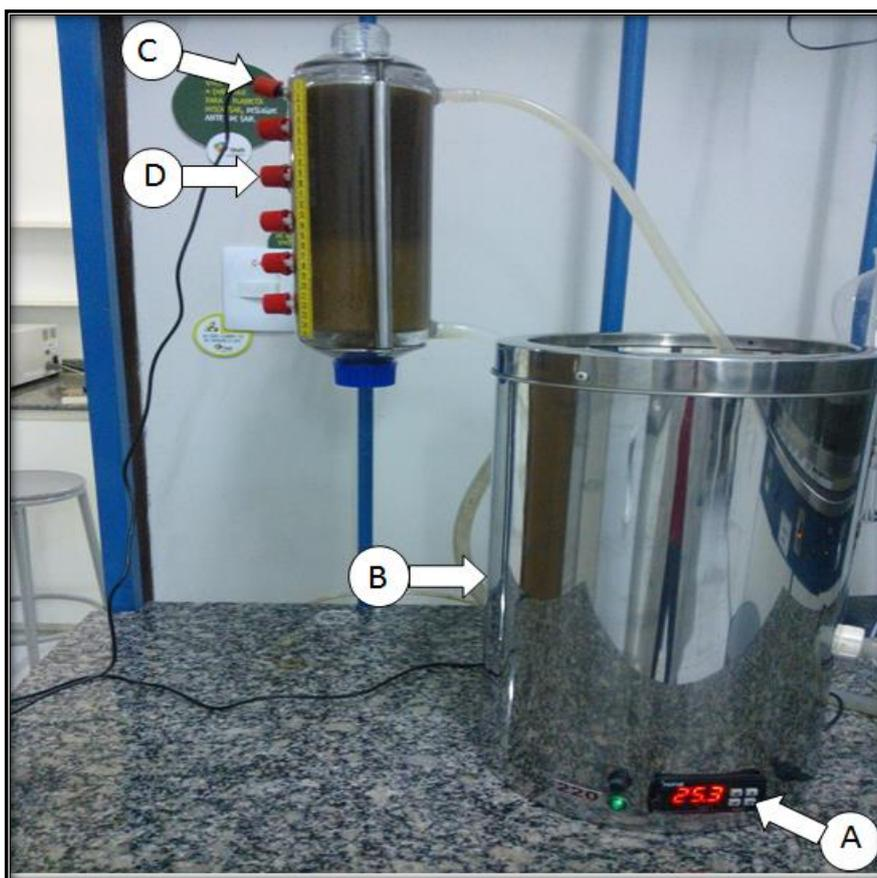
**Figura 31:** Aparato experimental empregada para o acompanhamento da interface óleo/emulsão e realização de coletas de amostras (análise de DTG e teor de água) da emulsão. A) indicador de temperatura, B) banho termostático, C) termopar aclopada no vaso separador para o controlar a temperatura e D) pontos de coletas de amostras da emulsão.
