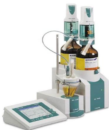
**Figura 29:** Titulador Potenciométrico - Modelo Titrand 836 (Metrohm).
