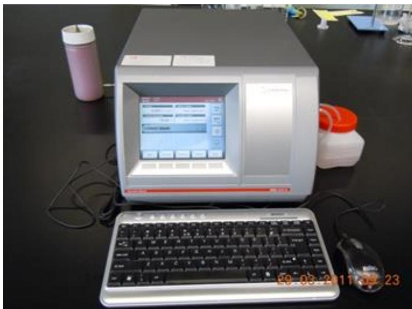
Figura 34: Densímetro da Anton Paar - modelo DMA 4500
