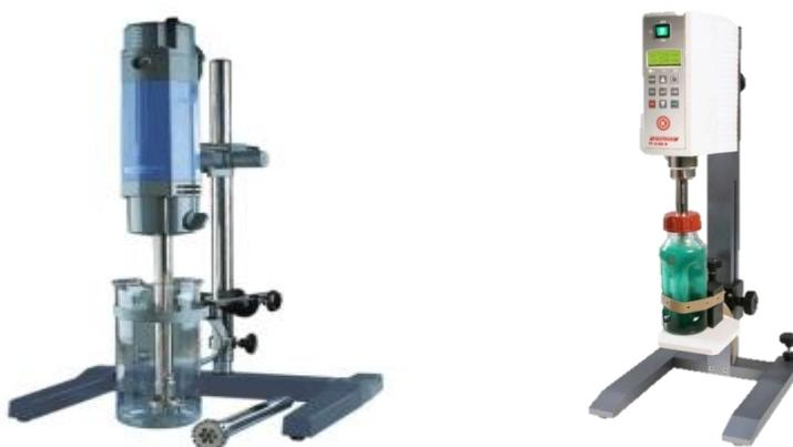
**Figura 9:** Homogeneizador Ultra-Turrax T-25 Basic - IKA e D 3100 PT – Polytron.
