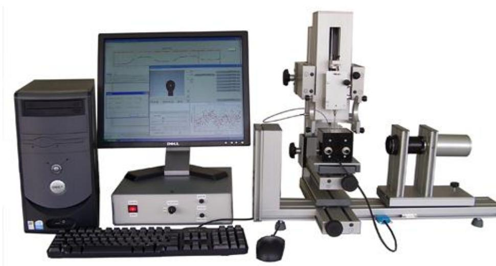
**Figura 15:** Tensiômetro de gota pendente Tracker Teclis.
