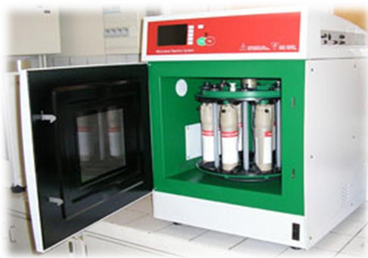
**Figura 13:** Reator micro-ondas multimodo batelada Synthos 3000 Anton Paar.
