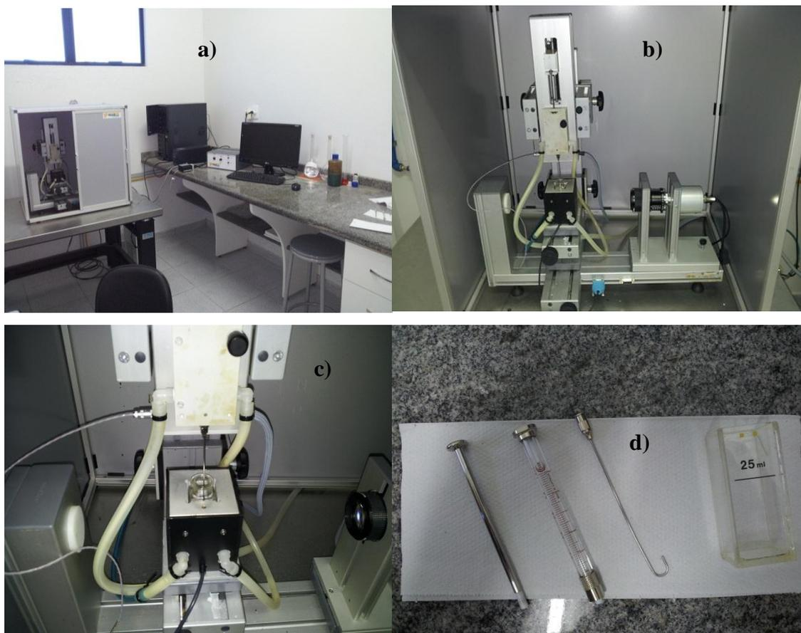
**Figura 11:** Imagens do tensiômetro de gota pendente e dos seus componentes disponível no Núcleo de Sistemas Coloidais (Nuesc). a) sistema tensiômetro/computador. b) Imagem panorâmica dos equipamentos internos do tensiômetro. c) Imagem focalizada do conjunto cubeta/seringa e da câmera CCD. d) Cubeta, seringa e agulha em formato de U.
