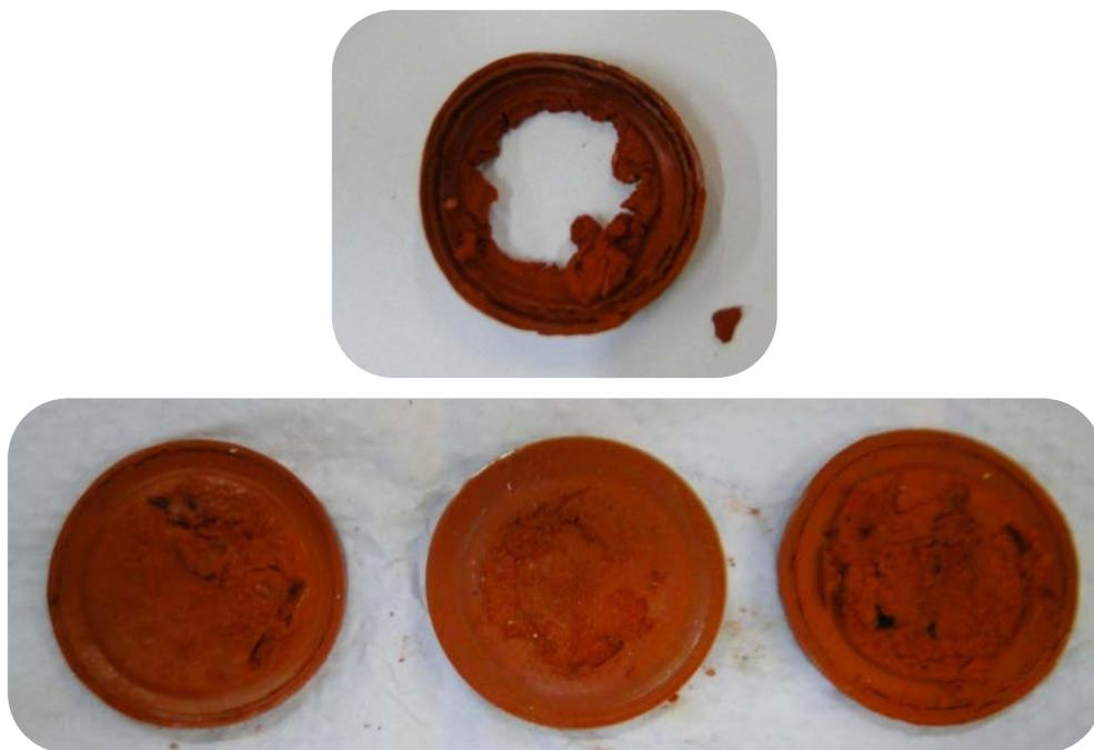
**Figura 16**-Sistema de vedação dos reatores de polpação desgastados após ensaios mais longos
