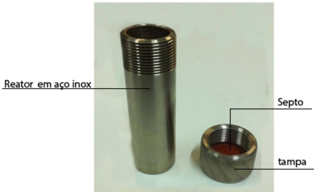
**Figura 14** - Reator de aço inox empregado no processo de polpação
