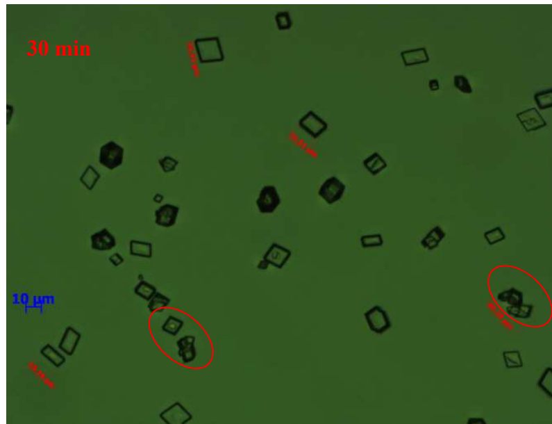
Figura 17: (a) Efeito do tempo de precipitação de carbonato de cálcio em água na concentração de íons cálcio de 10 \text{ mMol L}^{-1} na temperatura de 298 K. Imagens obtidas com microscopia ótica.
