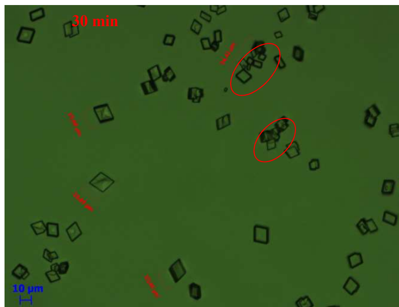
Figura 17: (b) Efeito do tempo de precipitação de carbonato de cálcio em água na concentração de íons cálcio de 50 \text{ mMol L}^{-1} na temperatura de 298 K. Imagens obtidas com microscopia ótica.
