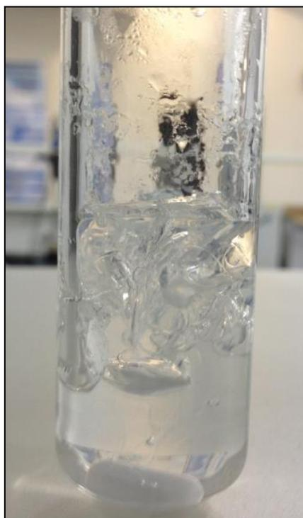
Figura 14 – Imagem da sílica SiS-80/40 Cl<sup>-</sup> gelificada no reator micro-ondas.
