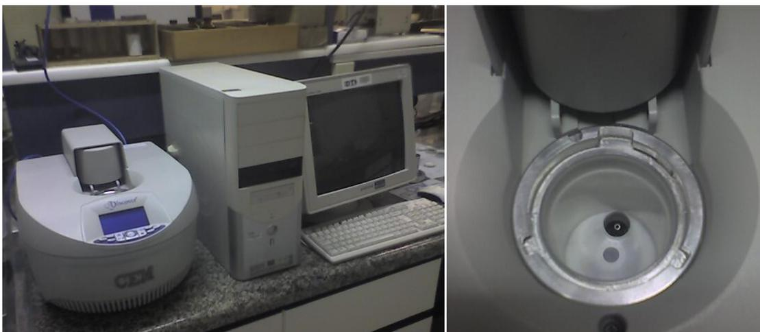
Figura 24: Micro-ondas monomodo da marca CEM, modelo Discover com detalhes da cavidade única que recebe a emissão das ondas.
