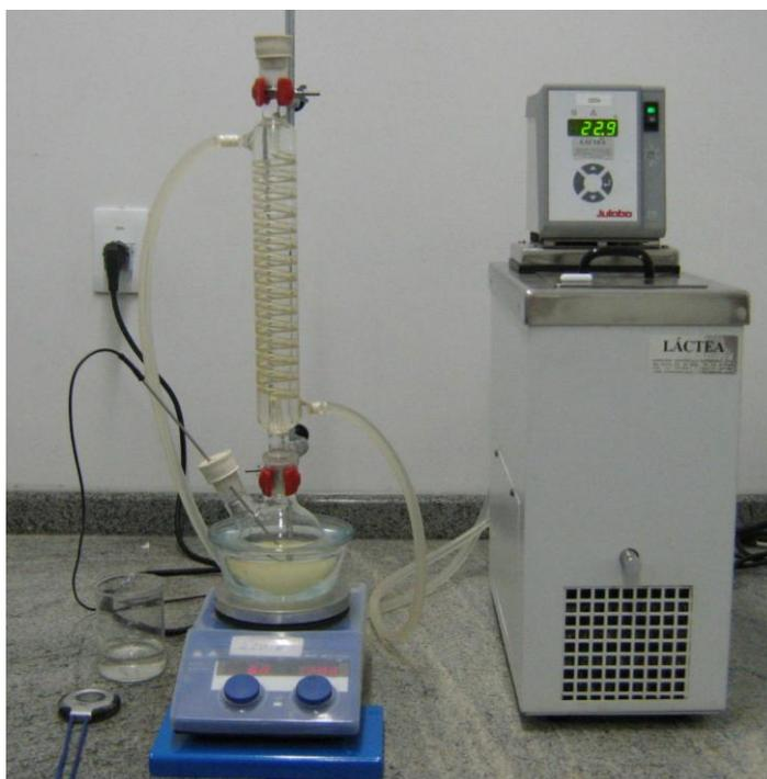
Figura 21: Sistema utilizado nas reações com aquecimento convencional.
