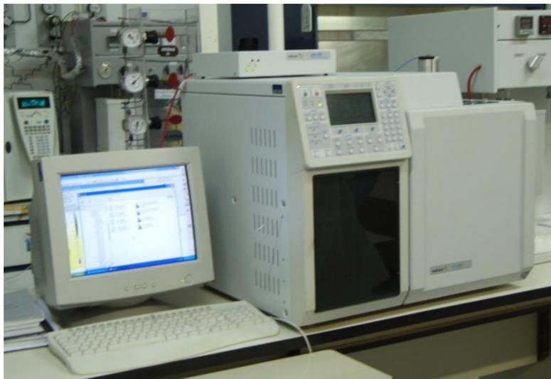
Figura 25: Cromatógrafo gasoso - Marca VARIAN modelo CP- 3800.
