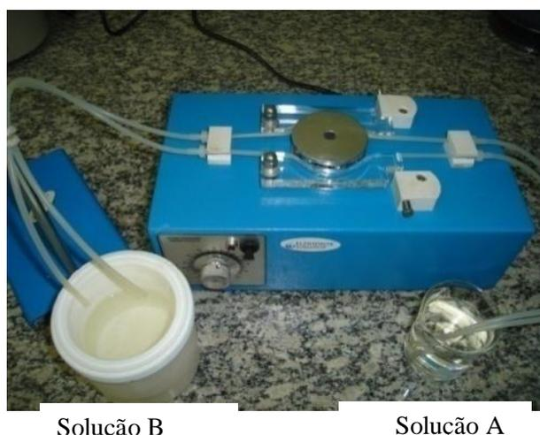
Figura 9. Esquema de síntese da hidrotalcita por coprecipitação.
