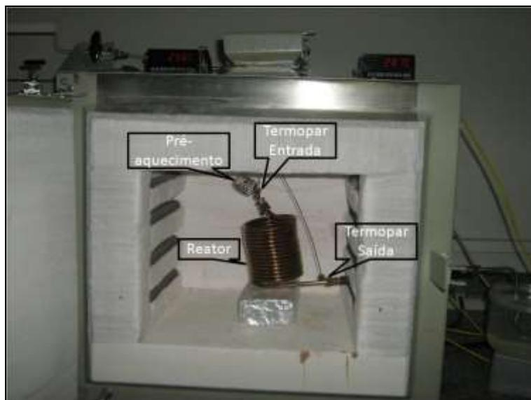
Figura 23: Detalhe do reator tubular inserido no interior do forno de aquecimento com conexões para os termopares e zona de pré-aquecimento.
