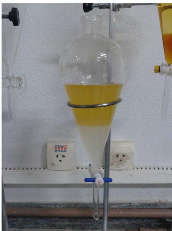
**Figura 16** – Biodiesel e água
