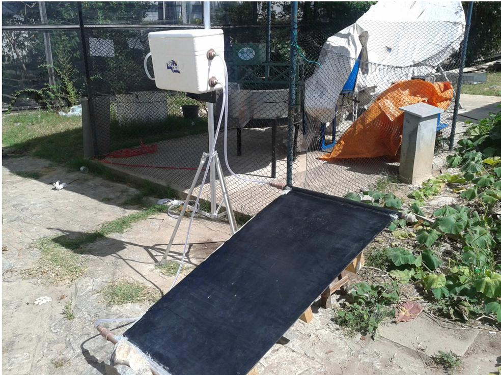
**Figura 8** – Montagem do termossifão e reservatório de água
