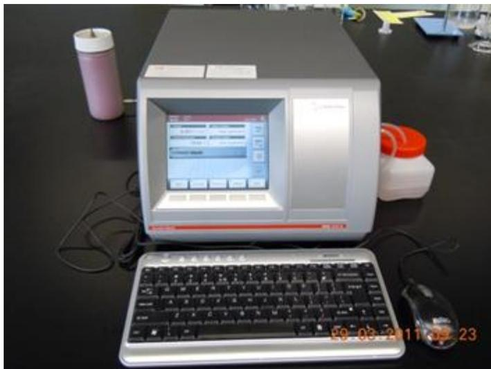
**Figura 27: Densímetro Anton Paar modelo DMA 4500.**
