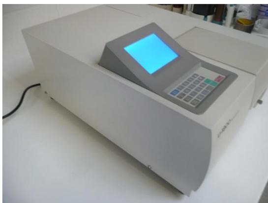
**Figura 23: Espectrofotômetro UV-Visível Hitachi U1800.**
