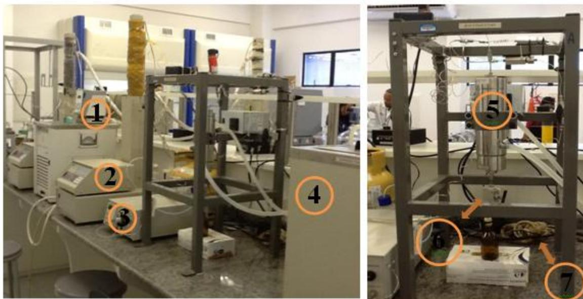
**Figura 13:**Fotografia do sistema utilizado. (1 e 4) Banhos termostáticos; (2) Bomba de seringa; (3)Bomba de deslocamento positivo; (5) Extrator; (6) Válvula agulha; (7)Fita de aquecimento.
