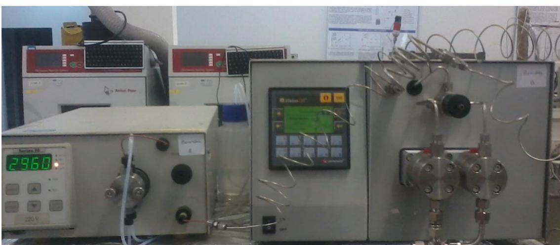
**Figura 18: Sistema de Bombas da Unidade integrada de produção de biodiesel. Bomba A com vazão de até 10 mL/min e Bomba B com vazão até de 300 ml/min.**
