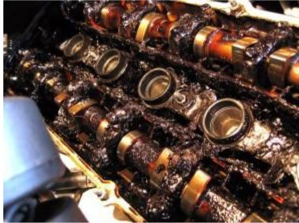
**Figura 7: Motor de ignição por compressão que usava óleo vegetal (SANTOS, 2008).**
