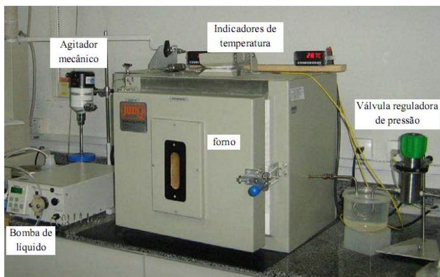
**Figura 15: Unidade para a produção de Biodiesel em meio supercrítico.**
