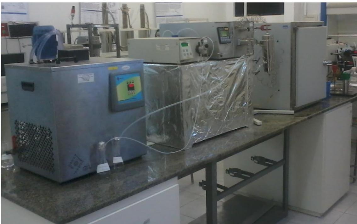
**Figura 17: Unidade integrada para extração de óleo vegetal e produção de Biodiesel em meio pressurizado.**
