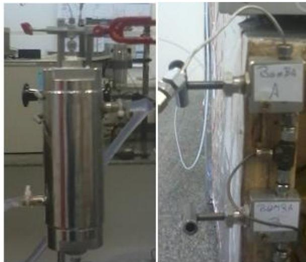
**Figura 19: Detalhamento da unidade integrada compreendendo extrator e válvulas de controle das bombas.**
