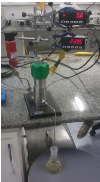
**Figura 21: Válvula reguladora de pressão do Sistema e sistema de monitoramento de temperatura e pressão.**
