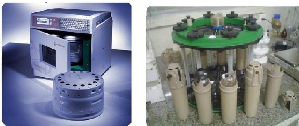
**Figura 10:** Reator Micro-ondas: cavidade e detalhe do rotor para inserção de 8 frascos.
