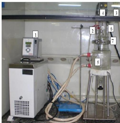
(1) Banho termostático; (2) Sonda NIR; (3) Condensador; (4) Agitador mecânico; (5) Reator de vidro; (6) Termopar; (7) Nitrogênio.
