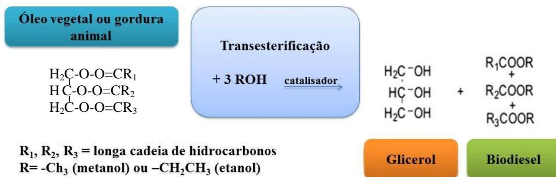
**Figura 1-** Produção de biodiesel: reação de transesterificação (adaptado de LEONETI *et al.*, 2012).
