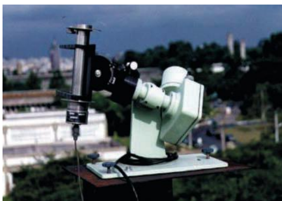
Figura 10 – Piroheliômetro Fonte: (OLIVEIRA, 1997)
