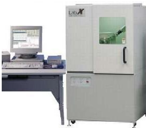
Figura 34 - Difratômetro Shimadzu modelo XRD-6000 (ICP-CSIC - Espanha)
