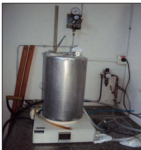
Figura 29 - Calcinador THERMA (TH 2031P-201) (LCEM – ITP)
