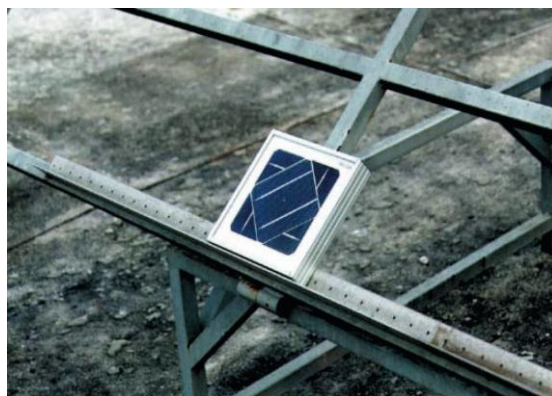
Figura 9 – Piranômetro fotovoltaico Fonte: (OLIVEIRA, 1997)
