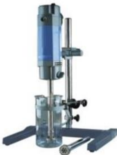
Figura 5: Homogeneizador Ultra-Turrax T – 25 Basic – IKA.
