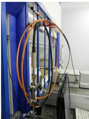
Figura 3.4: Fibra óptica e sonda de transflectância.
