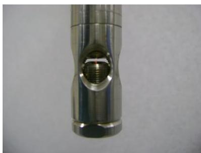
Figura 3.5: Extremidade da Sonda de transflectância.
