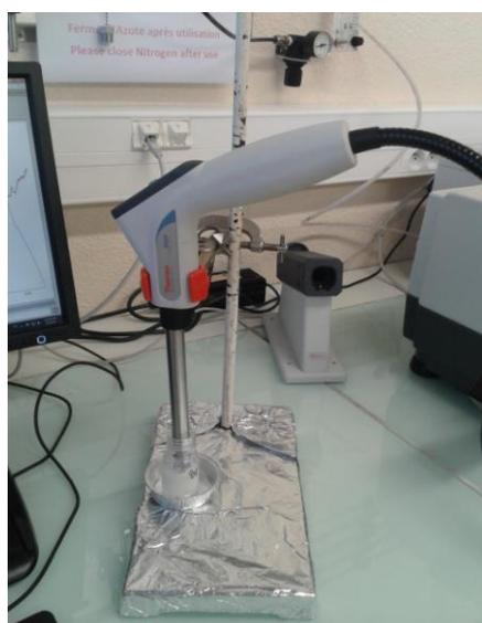
Figura 4.3: Fibra óptica e sonda de reflectância.
