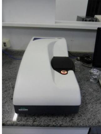
Figura 3.2: Espalhamento Dinâmico de Luz – DLS (Zetasizer, Nano Series da Malvern)
