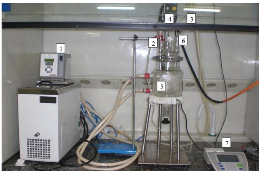
Figura 3.1: (1) Banho termostático; (2) Sonda NIR; (3) Condensador; (4) Agitador mecânico; (5) Reator de vidro; (6) Termopar; (7) Condutivímetro.
