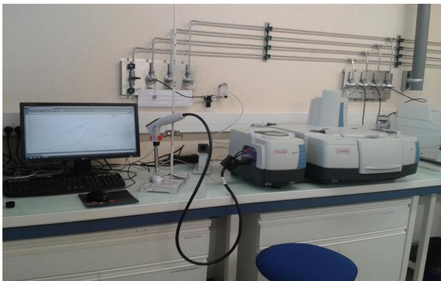
Figura 4.2: Espectrofotômetro no Infravermelho Próximo (NIR) - Thermo Scientific Nicolet iS50 FT-IR Spectrometer.
