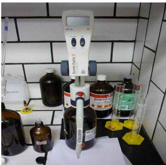
Figura 20 – Bureta digital do laboratório de análise de água de Carmópolis.
