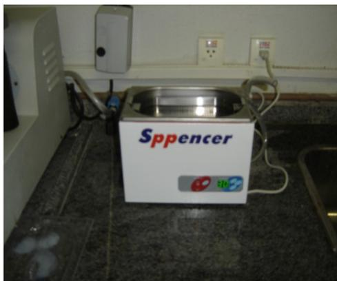
Figura 22 – Ultrassom SPENCER para limpeza das amostras e dos eletrodos.
