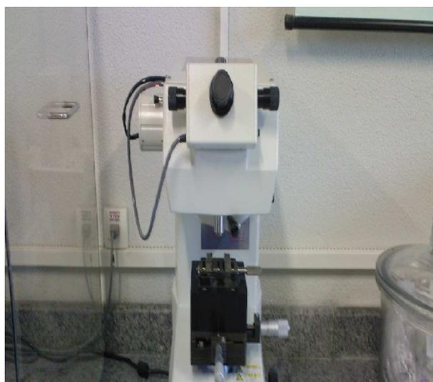
Figura 13 – Microdurômetro Shimadzu HMV-2 do LEM-ITP/UNIT.
