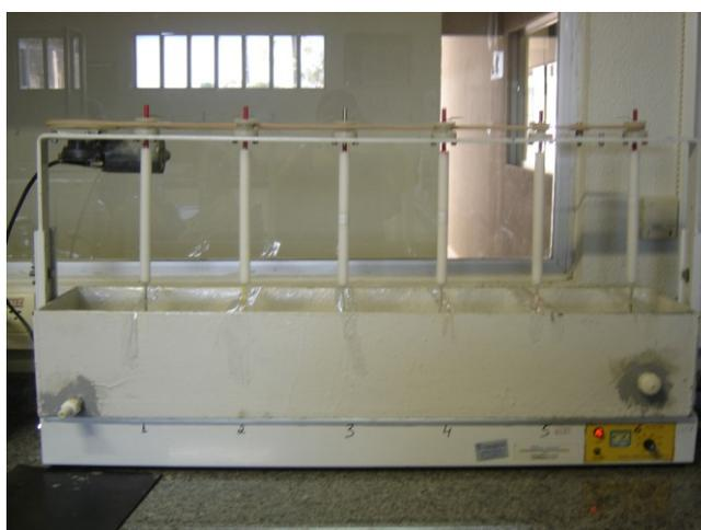
Figura 23 – JAR-TEST modificado utilizado no ensaio de variação do potencial de circuito aberto do LEM-ITP/UNIT.
