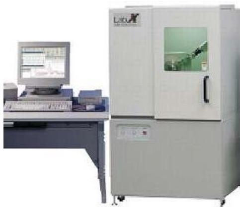
**Figura 3:** Difratorômetro Shimadzu modelo XRD-6000.
