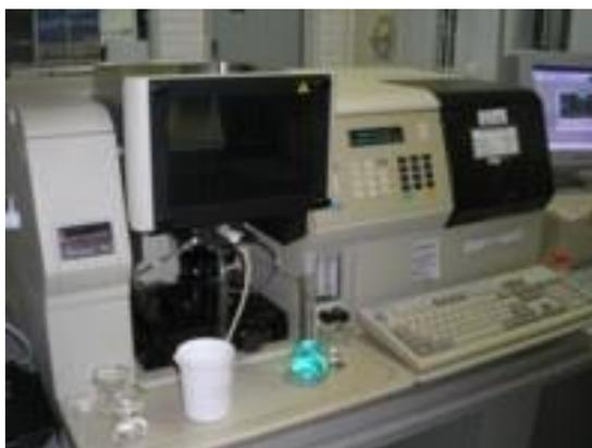
**Figura 2:** Espectrômetro de absorção atômica do laboratório de absorção atômica do Centro de Pesquisa e Desenvolvimento – CEPED, em Camaçari no Estado da Bahia.
