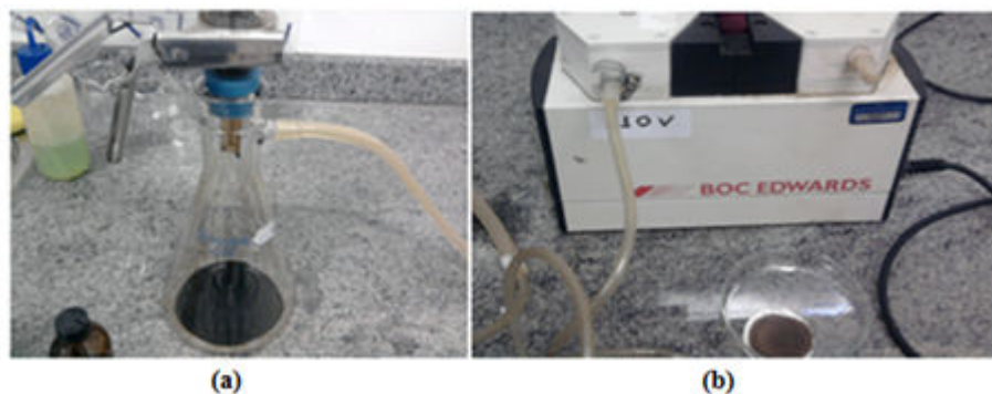
Figura 17: (a) Filtragem do heptol a vácuo. (b) Bomba a vácuo, abaixo funil com a membrana após lavagem e primeira solução filtrada.
