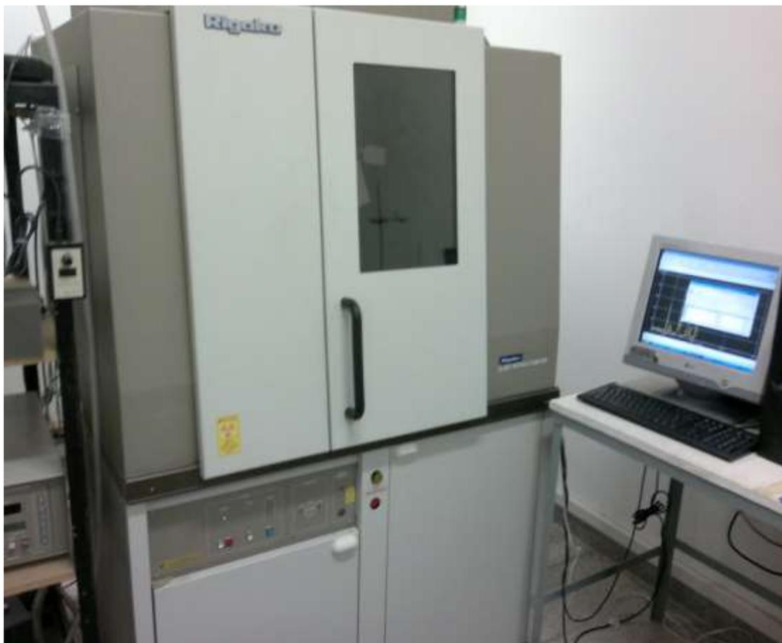
**Figura 10:** Difrátômetro RIGAKU RINT 2000/PC localizado no Departamento de Física da UFS-SE.
