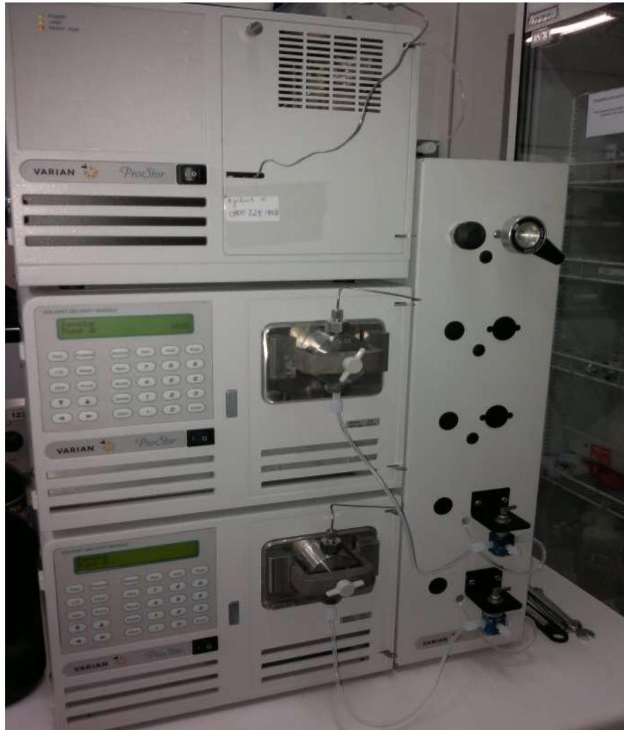
**Figura 13:** Cromatógrafo líquido do LPA/ITP onde foram realizadas as análises de degradação do herbicida atrazina.
