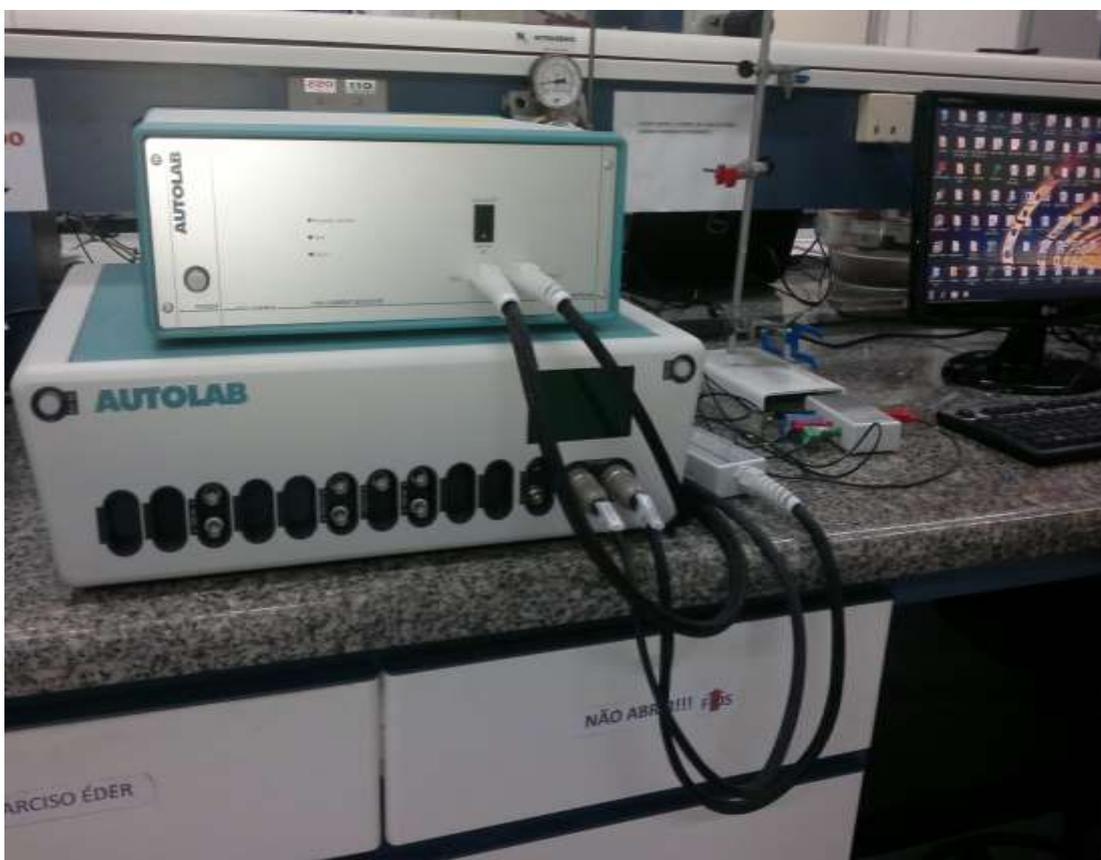
**Figura 11:** Potenciostato/Galvanostato Autolab PGSTAT do Laboratório de Eletroquímica e Nanotecnologia/ITP-UNIT
