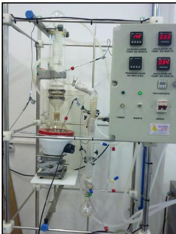
Figura 1. Coluna de destilação modular empregada na destilação fracionada do petróleo.
