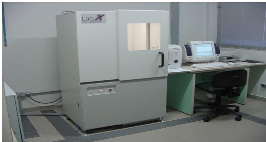
**Figura 4.4:** Difratorômetro XRD-6000 da marca Shimadzu em Natal/RN.
