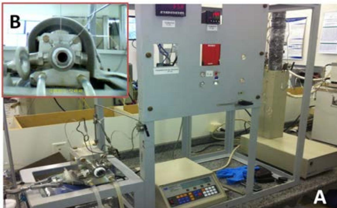
Figura 8: (A) Visão geral do aparato experimental e (B) visão frontal da célula de equilíbrio.
