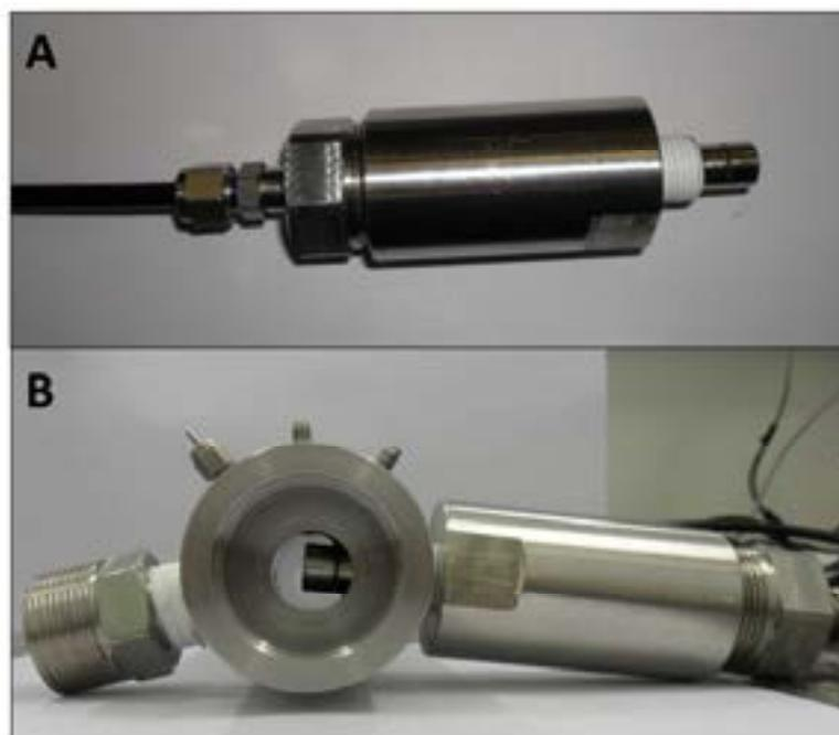
Figura 24: Imagens da sonda NIR (A) acoplada ao sistema de vedação e (B) conectada na célula de equilíbrio com caminho ótico no interior.
