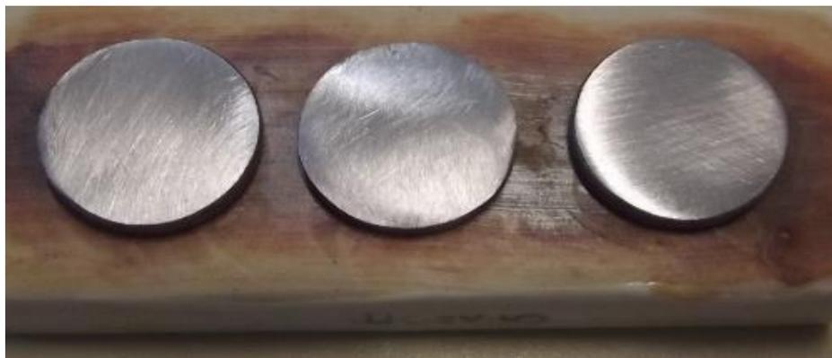
**Figura 13.** Eletrodos de aço carbono SAE 1020 não revestidos.
