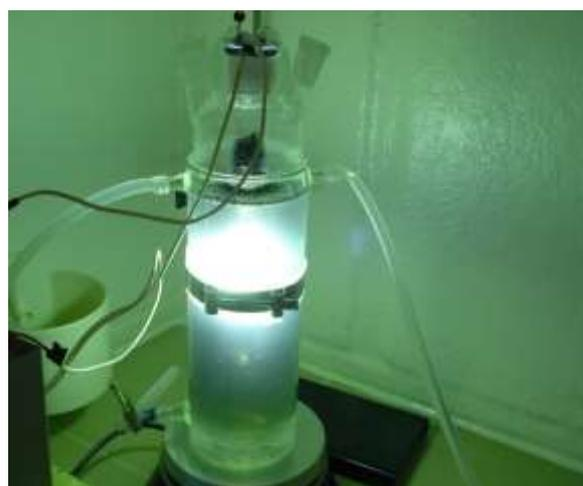
**Figura 12:** Reator fotocatalítico experimental.
