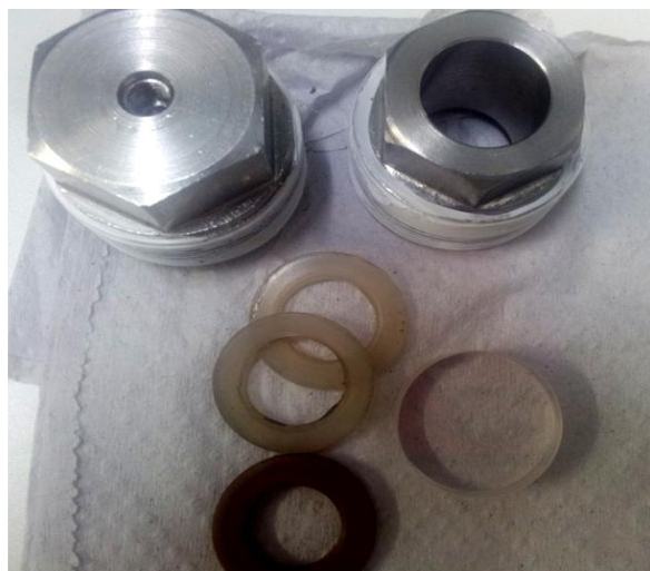
Figura 14 - Detalhe das conexões de fechamento da célula com respectivos anéis de vedação e janelas de safira.
