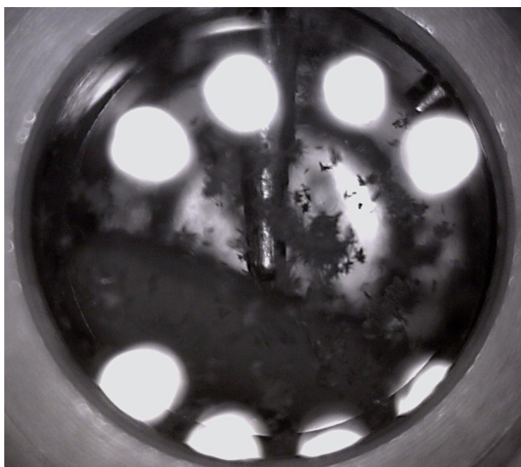
Figura 17 - Imagem frontal da célula captada pela câmera microscópica com a formação de precipitados.
