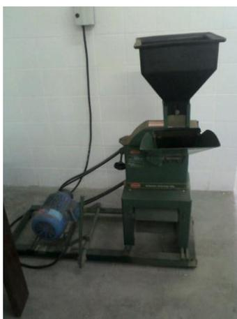
**Figura 02.** Forrageira (modelo DPC-01, marca Cremasco Máquinas Agrícolas) utilizada no processo de moagem do sabugo do milho.
