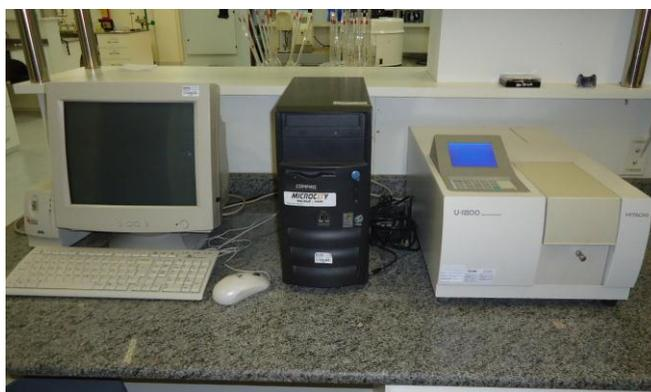
**Figura 12.** Espectrofotômetro UV-visível, modelo U-1800 (HITACH) utilizado no procedimento analítico para determinação da concentração do TOG.
