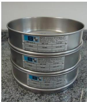
**Figura 03.** Peneiras do tipo Tyler, marca Bertel Indústria Metalúrgica Ltda. utilizadas no processo de classificação granulométrica do sabugo do milho.
