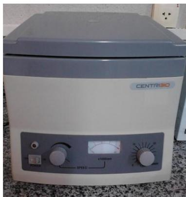
**Figura 11.** Centrífuga, modelo 80-2B, marca Centribio, utilizada para separação de possíveis impurezas nas amostras.
