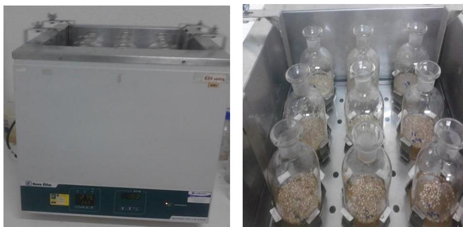
**Figura 09.** Banho Dubnoff, modelo 501 / 3D, marca Nova Ética com frascos submetidos a agitação e temperatura constantes.
