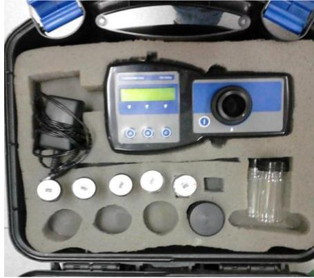
**Figura 04.** Turbidímetro, modelo TB 1000p, marca Tecnopon utilizado para determinar a influência da turbidez gerada pelos grânulos do sabugo do milho.
