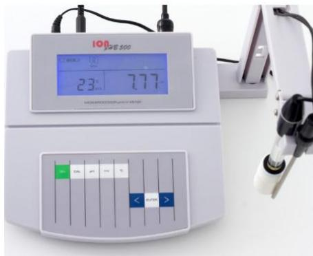
**Figura 05.** pHmetro digital, modelo pHB 500, marca ION utilizado para determinar o pH das amostras durante os experimentos.
