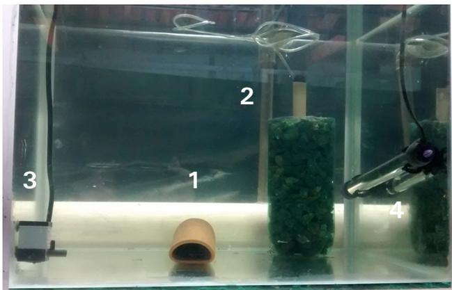
**Figura 4.** Aquário de 60 L contendo: 1) abrigo de cerâmica, 2) filtro biológico, 3) bomba submersa e 4) aquecedor com termostato.
